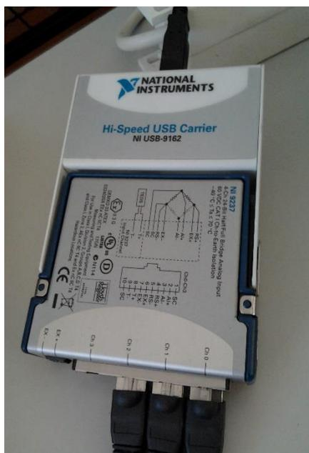
Figura E- Instrumento de aquisição de dados modelo NI USB-9162
