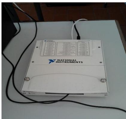
Figura G - Instrumento de aquisição de dados modelo DAQPad-6015/6016
