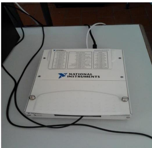
**Figura 3-9 - Instrumento de aquisição de dados modelo DAQPad-605/6016**
