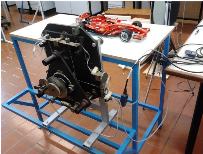
Figura 3-4 - Mesa de ensaios de ligação entre a balança aerodinâmica e o modelo
