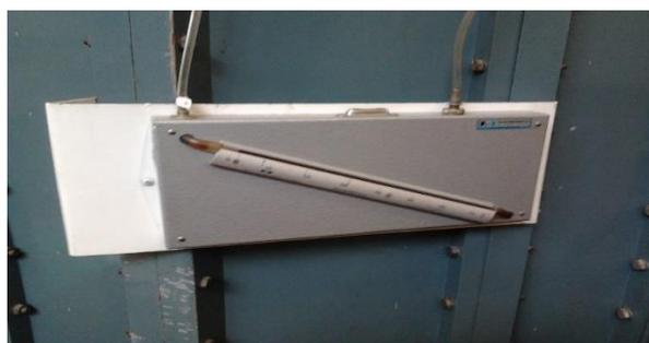
Figura 3-21 - Leitor de valores de diferença de pressão à entrada e saída do túnel de vento
