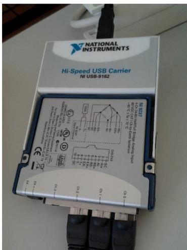
**Figura 3-7 - Instrumento de aquisição de dados modelo NI USB-9162**
