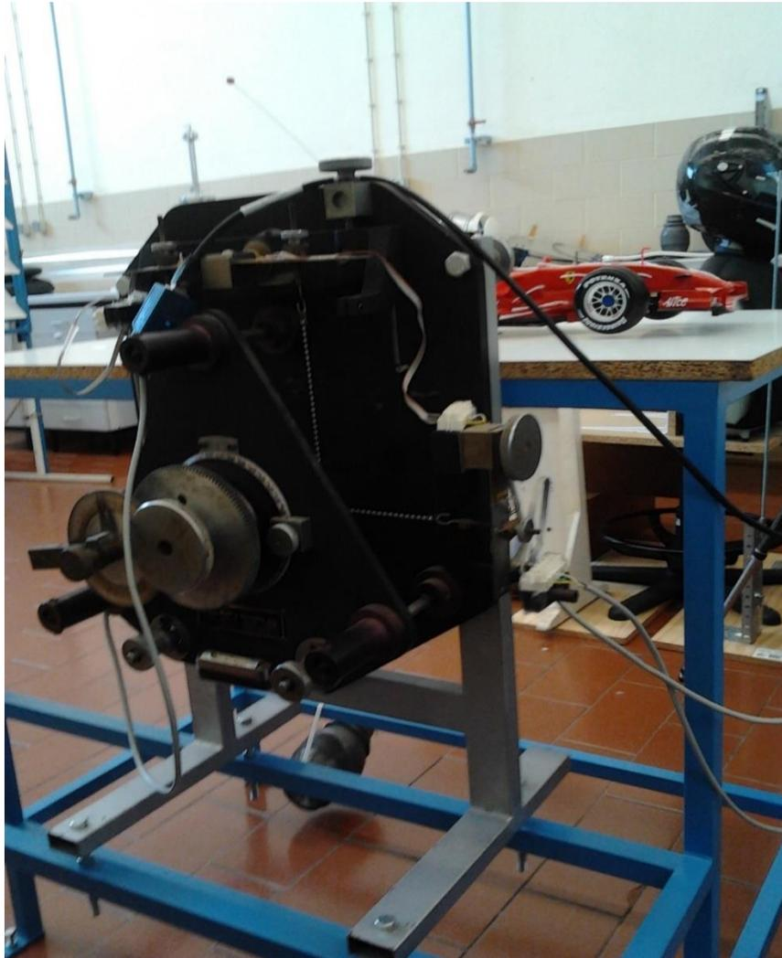
**Figura 3-2 - Balança aerodinâmica presente no Laboratório de Mecânica dos Fluidos do DEM**
