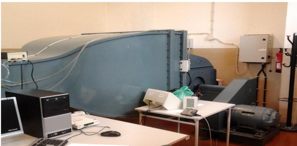
Figura A - Túnel aerodinâmico
