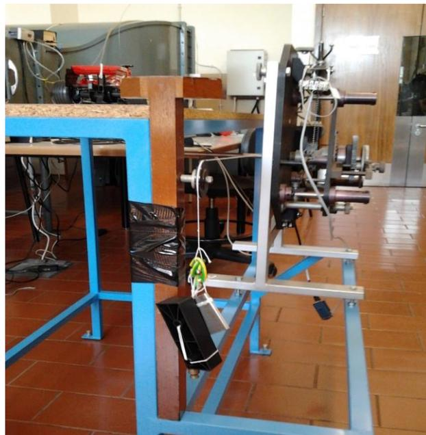
Figura 3-127 - Método de colocação dos objetos para a calibração de  $F_X$
