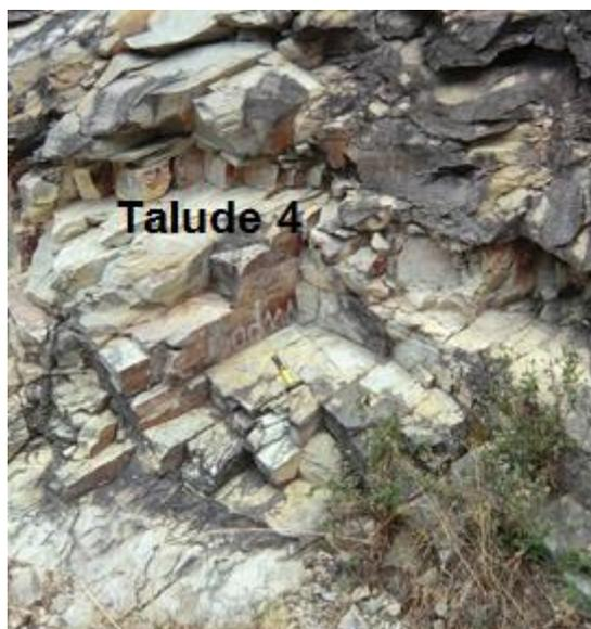
Figura 5.5 – Representação de roturas em cunha no segundo troço do Talude 4.
