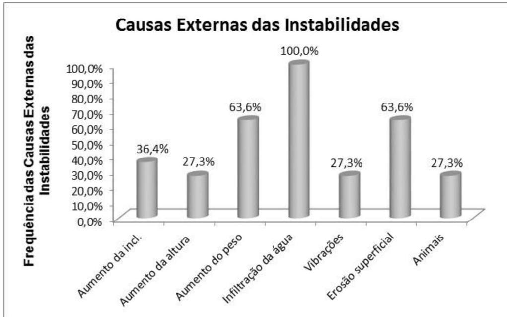
Figura 5.18 - Causas externas das situações de instabilidade detetadas nos taludes.
