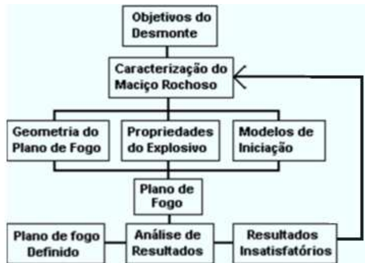
Figura 6.1- Fluxograma mostrando importância da caracterização no planeamento de fogo, para cada região do maciço ( Candia et al.,2004)
