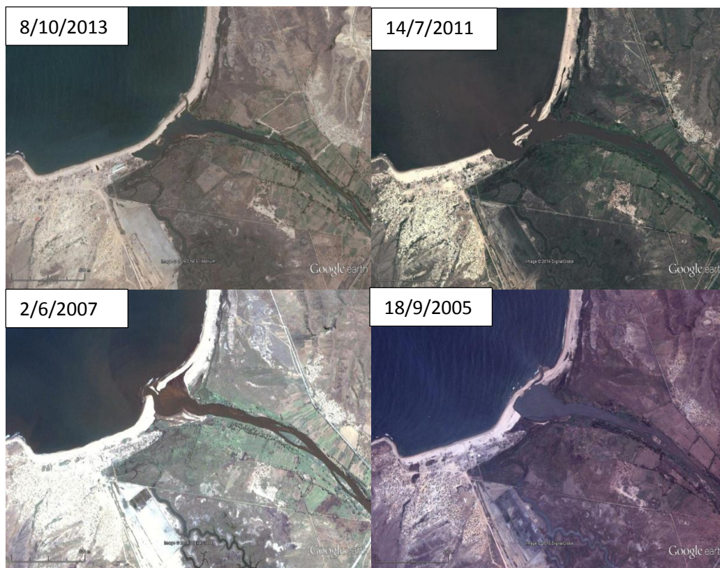
Figura 4.12 – Aspeto das mudanças verificadas na configuração da embocadura do rio Quicombo (Sumbe, Angola).
