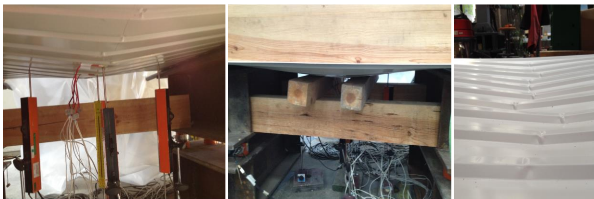
Figura 4.15 – Colapso dos provetes de chapas perfiladas com secção T14 - 1 vão
