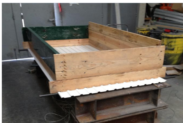
a) Reservatório de madeira (ensaio do provete T14 - 2 vãos)
