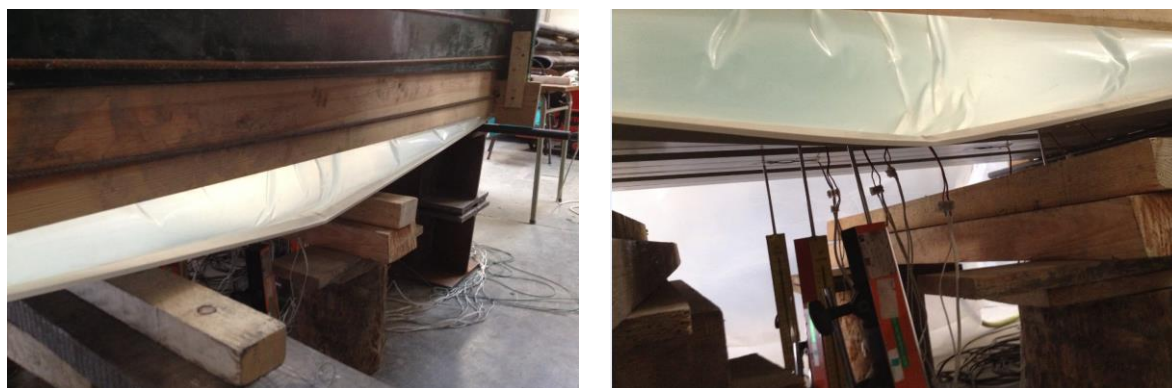
Figura 4.12 – Colapso dos provetes de chapas perfiladas com secção T5 - 1 vão
