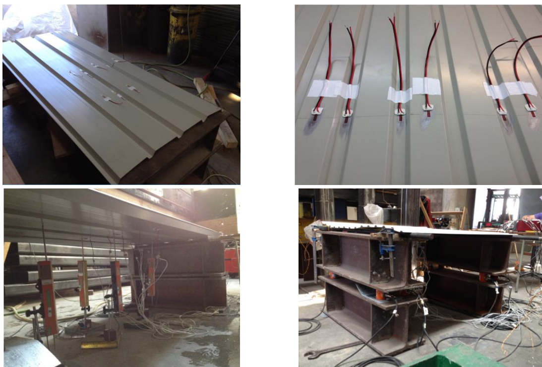
Figura 4.10 – Instrumentação dos provetes e preparação do sistema de ensaio
