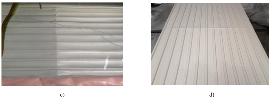
Figura 4.18 – c e d) Colapso dos provetes com secção T14 - 2 vãos de 1 metro (continuação)
