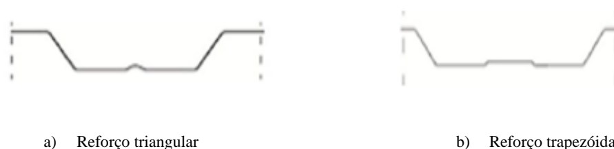
Figura 2.11 – Tipologias de reforços longitudinais utilizados nos banzos comprimidos (Martins, 2011)
