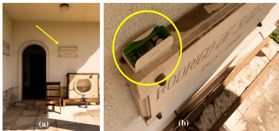
Figura 3.9 – Fotografia (a) indicando a posição do sensor externo. Local coberto, protegido da radiação solar e de forma discreta. Fotografia (b), caixa a proteger o sensor externo evidenciado, reparar que está fixado com fita cola para proteção contra o vento
