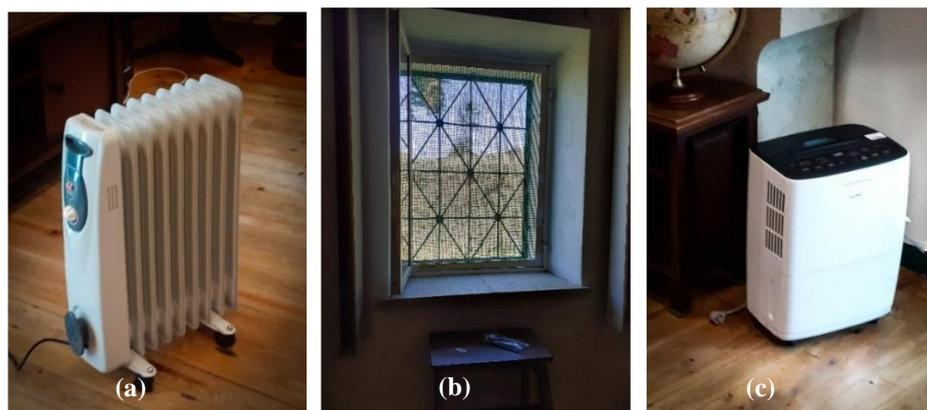
Figura 4.7 – Imposições semanais ao microclima, aquecedor (a) de 1500 W (o segundo aquecedor não está representado), ventilação natural por meio de janela com tela protetora (b) e desumidificador (c)
