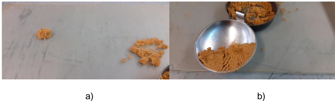
Figura 35 – Demonstração das tentativas goradas de realização do ensaio de determinação dos limites de Atterberg.
