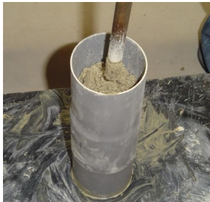
Figura 22 - Pormenor da compactação com apiloamento.
