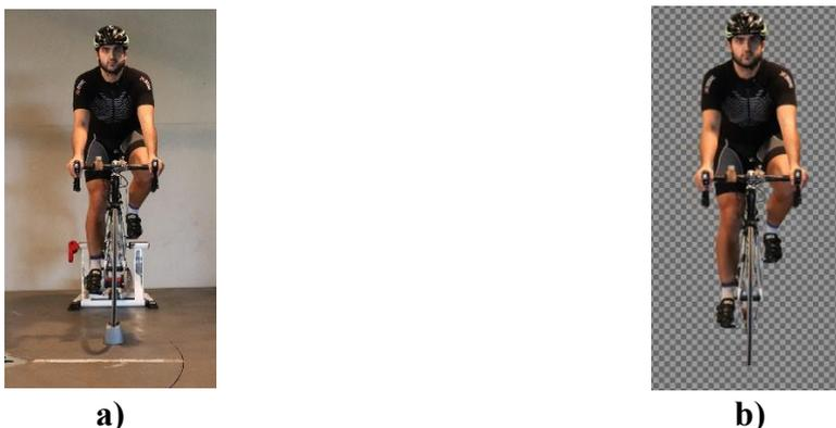
**Figura 3.1.** Fotografia usada para a obtenção do valor da Área Frontal Efetiva antes (a) e depois (b) de aplicado o pós-processamento
