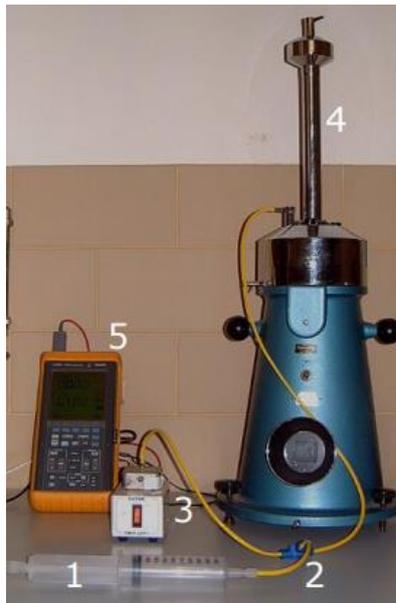
**Figura 3.6.** Montagem experimental utilizada na calibração de um sensor capacitivo de pressão (21)
