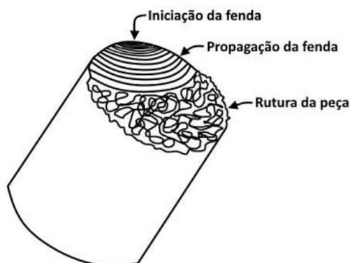
**Figura 2.1.** Imagem representativa dos três estágios principais da falha por fadiga (adaptado de Almeida, 2018).
