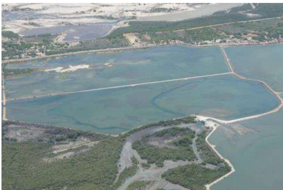
Figura IV.13- Fotografia aérea de salinas onde se observa o aprisionamento de canais de drenagem naturais. Fonte: Frederico Fonseca/IBAMA, 2013.
