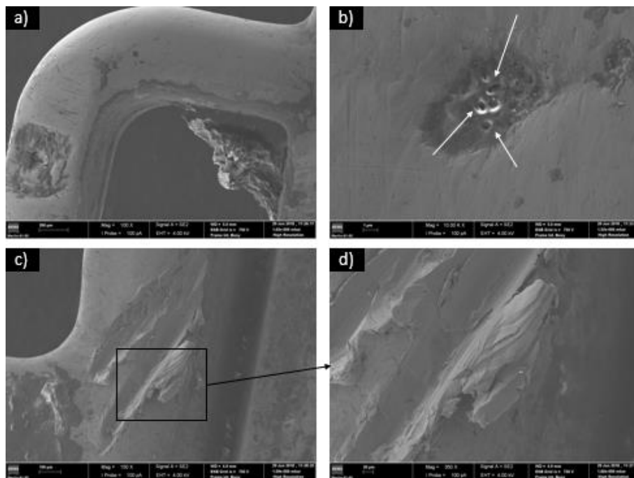
Figura 4.8 - Morfologia em superfície de tubo, por SEM, após 2 anos de uso clínico.
