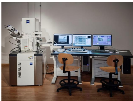
Figura 3.6 – Equipamento de SEM/EDS do Laboratório de Materiais e Desgaste do IPN. Foto retirada do site do IPN 53 .
