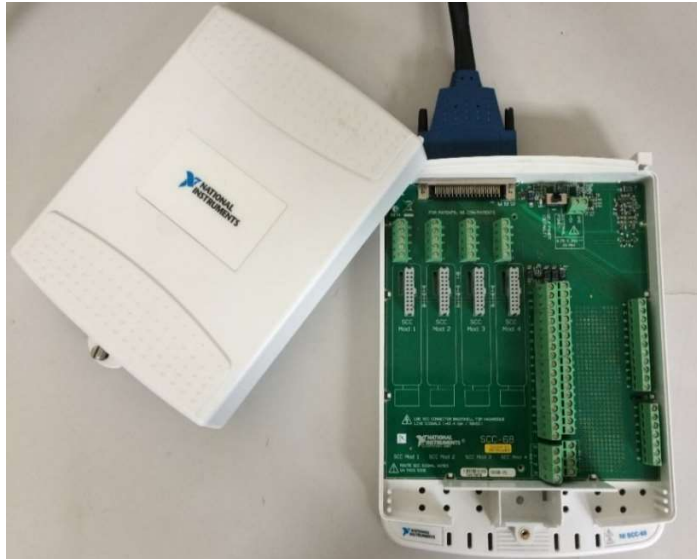
Figura 3.6. Placa SCC-68, da National Instruments (Caixa de terminais e condicionamento de sinal).
