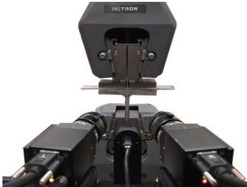
Figura 3.9 - Montagem do ensaio de arrancamento
