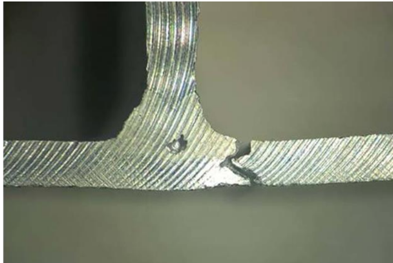
Figura 4.24 - Modo de ruína dos provetes nos ensaios de tração
