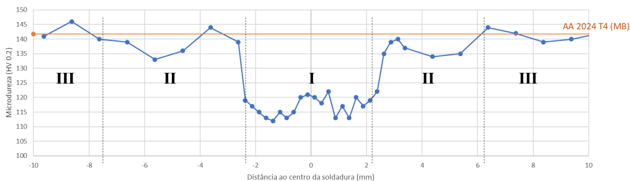
Figura 4.13 - Perfil de microdurezas ao longo do Skin (amostra 75): I-ZF, II-ZTA, III-MB
