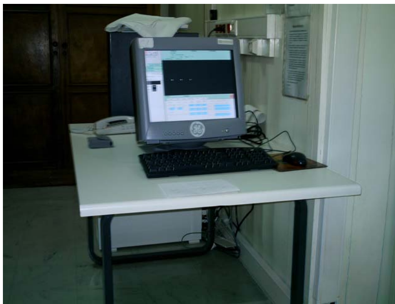
Figura VII-2. Sistema computadorizado que transforma a radiação gama emitida pelo doente ou voluntário numa imagem.
