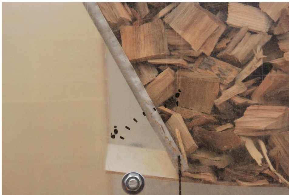
Figura 5.3. Representação do ângulo da tremonha com a vertical, com a tremonha carregada.
