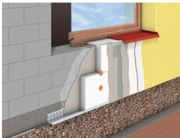
Figura 3.1 - Esquema de Isolamento pelo exterior - Sistema Capoto (Flavi Rebocos@, 2015)
