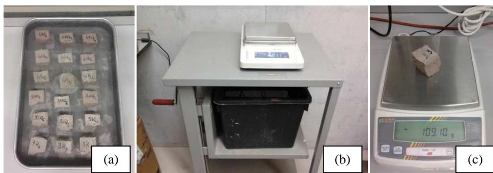
Figura 3.17 - Ensaio de porosidade e massa volúmica: (a) imersão total dos provetes; (b) pesagem dos provetes imersos; (c) pesagem dos provetes saturados
