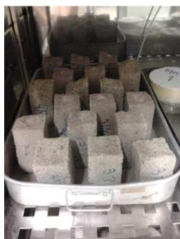
Figura 3.21 - Pormenor de provetes na câmara climática
