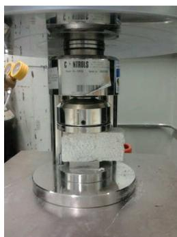
Figura 3.14 - Ensaio de resistência à compressão
