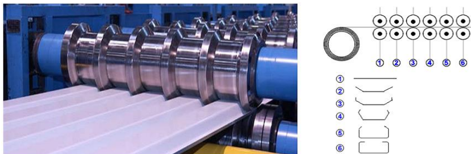
Figura 2.2 – Processo de fabrico por laminagem a frio (Silvestre e Camotim, 2006)
