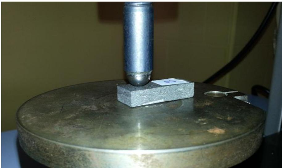
Figura 3.10 Ensaio de dureza
