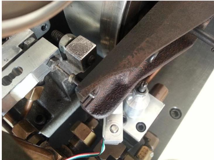
**Figura 3.14** Pormenor da ligação aparafusada com a célula de carga responsável pela medição da carga normal aplicada ao braço.
