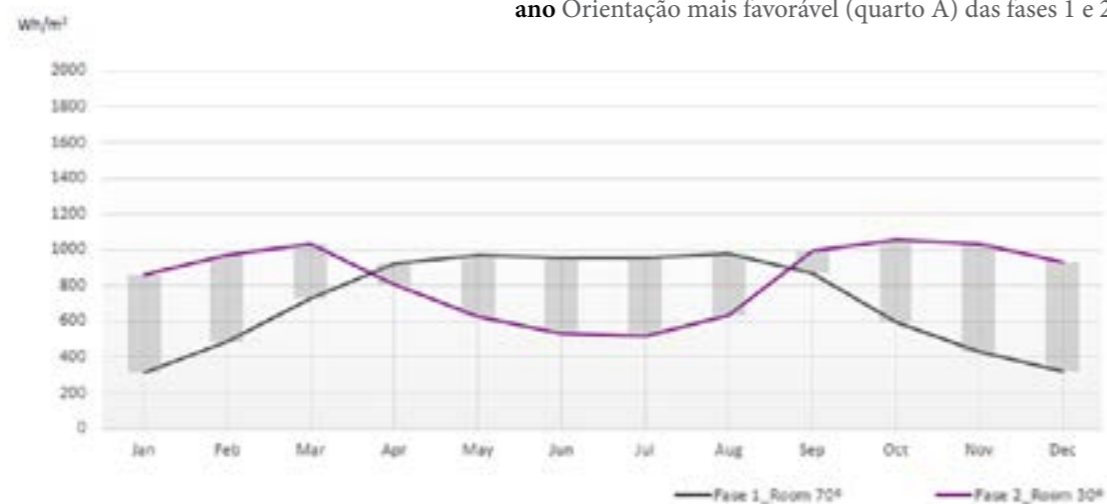
45. Gráfico da radiação incidente média mensal ao longo do ano Orientação menos favorável (quarto B) das fases 1 e 2
