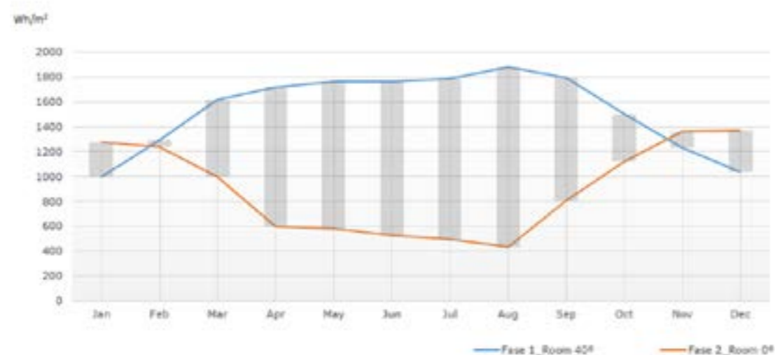
44. Gráfico da radiação incidente média mensal ao longo do ano Orientação mais favorável (quarto A) das fases 1 e 2
