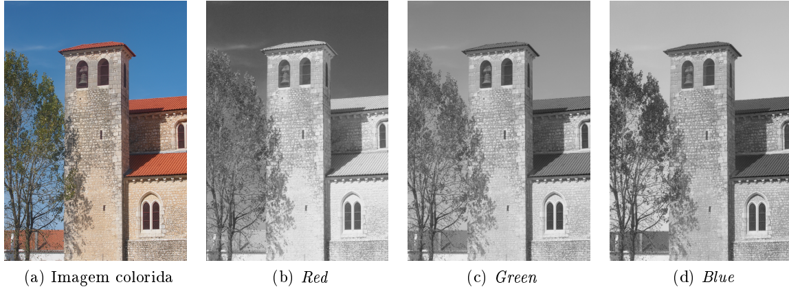
Figura 2.19: Representação gráfica de (a) uma imagem colorida RGB e das suas três componentes: (b) Red , (c) Green e (d) Blue .
