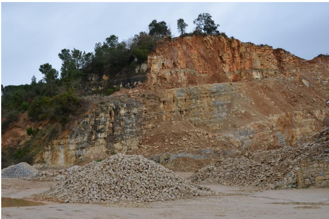
Figura 2.14. Frente de pedreira em laboração (Portunhos) onde é possível observar a sucessão carbonatada bajociana caraterística da Formação de Ançã, com o seu conteúdo fóssil e carsificação.
