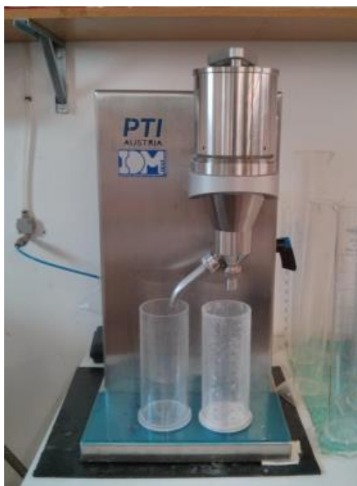
Figura 15 - Aparelho de análise da drenabilidade pelo método Schopper-Riegler .
