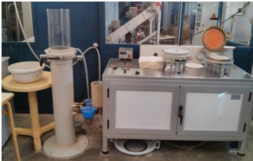
Figura 12 - Coluna de formação de folhas e secador.
