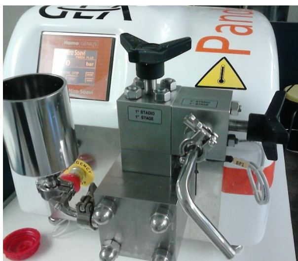
Figura 10 - Homogeneizador mecânico GEA Niro Soavi.
