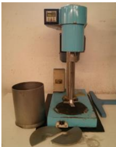
Figura 6 - Pulper de 2 litros para desintegração de fibra.
