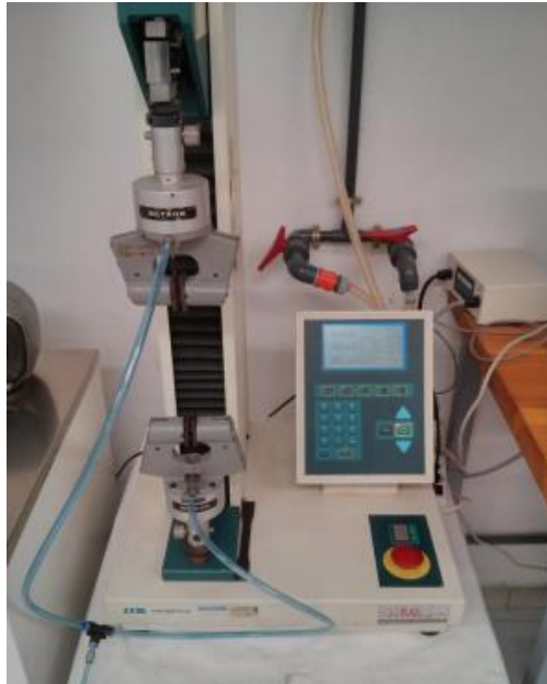
Figura 17 - Dinamómetro Hounsfield para determinar resistência à tração.
