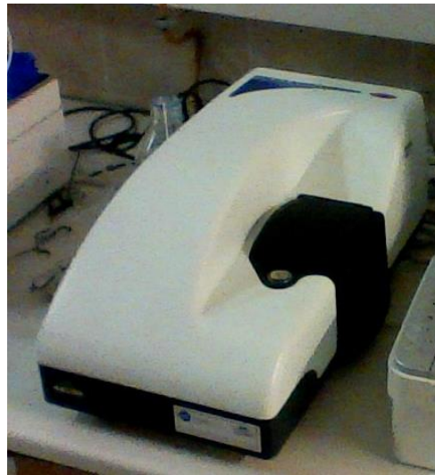
Figura 11 - Malvern Zetasizer Nano ZS utilizado na determinação da distribuição de tamanhos das NFC's.
