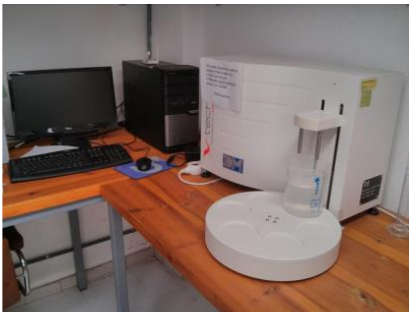
Figura 14 - Equipamento MORFI® para caracterização biométrica das fibras.
