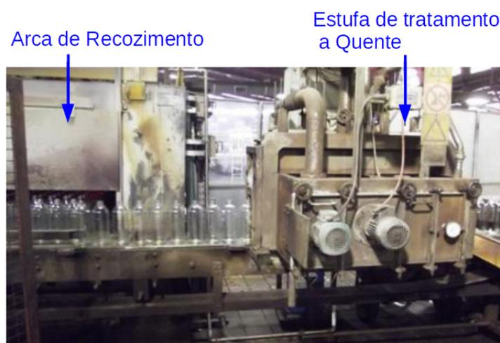
Figura 1.10: Fotografia evidenciando detalhe da fase de tratamento superficial a quente da superfície dos frascos de vidro produzidos na SGM. Após a sua formação, os frascos passam na estufa de tratamento a quente em direção à arca de recozimento.
