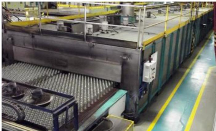
Figura 1.11: Detalhe fotográfico da arca de recozimento (SGM).
