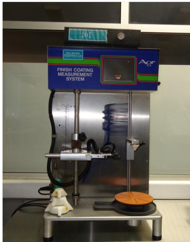
Figura 2.5: Detalhe fotográfico do aparelho de medição de espessura (tratamento a quente).
