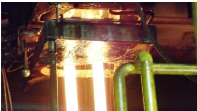
Figura 1.4: Detalhe fotográfico do local de saída das gotas de massa vítrea (gota dupla), antes da conformação, para os moldes SGM.
