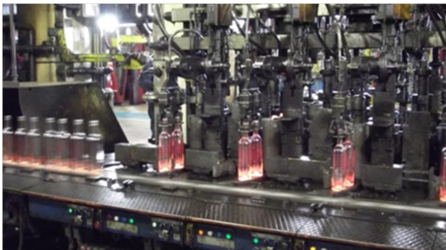
Figura 1.6: Fotografia da máquina IS de gota dupla da SGM evidenciando onde ocorre a desenformação da garrafa e sua colocação na linha de produção.
