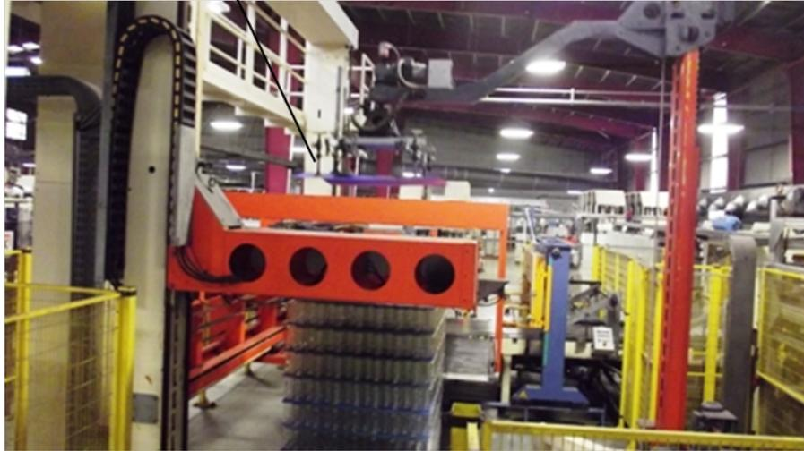
Figura 1.15: Detalhe fotográfico de uma máquina de embalagem evidenciando uma paleta em fase final de formação (SGM).
