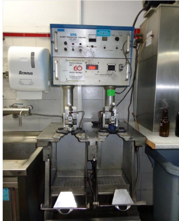
Figura 2.2: Detalhe fotográfico da máquina de medição da pressão interna máxima de rebentamento.
