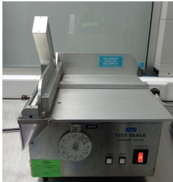
Figura 2.4: Detalhe fotográfico do aparelho de medição do ângulo de deslizamento (SGM).
