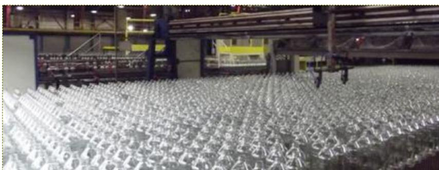
Figura 1.12: Detalhe fotográfico do transportador de frascos onde se procede ao tratamento superficial a frio (SGM).
