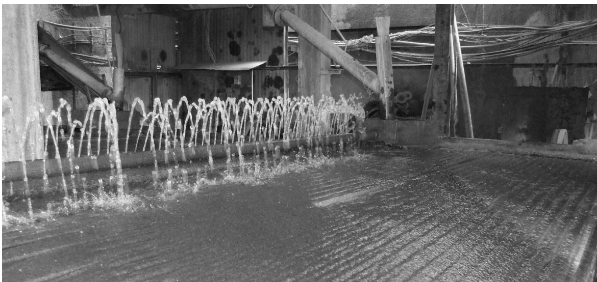
Figura 1.8 – Células de flutuação do tipo Denver ainda hoje em uso na lavaria da SBTWP (foto do autor agosto 2011)
