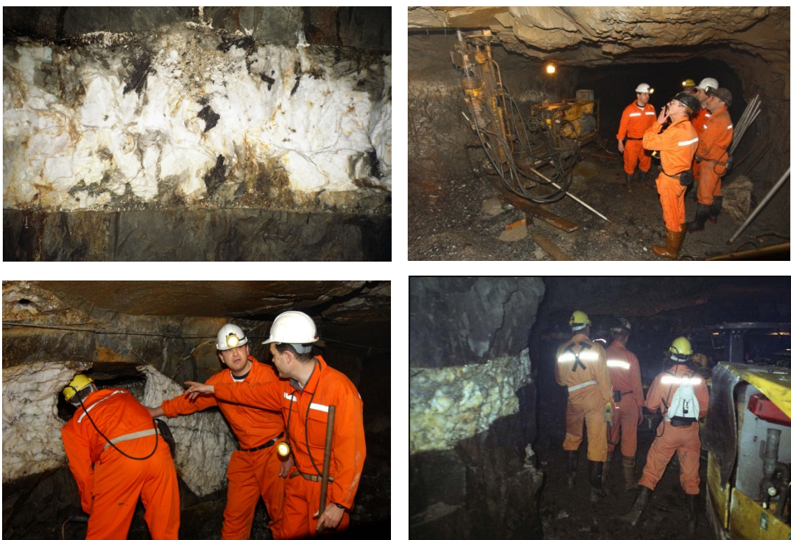
Figura 7.14 - Frente de desmonte na mina dos Rebordões, na Barroca Grande (Couto Mineiro da Panasqueira) da esquerda para a direita e de cima para baixo: filão mineralizado, abertura de uma chaminé, análise de um geode e frente de desmonte (fotos do autor, 2006).
