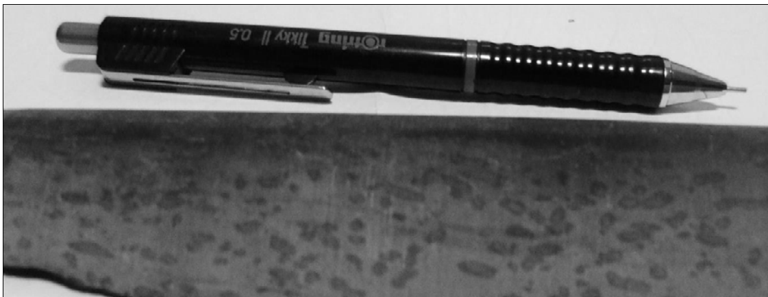
Figura 2.20 - Amostra de xisto mosqueado retirado numa sondagem efetuada pela BTWP. (Fotografada pelo autor, 2006)
