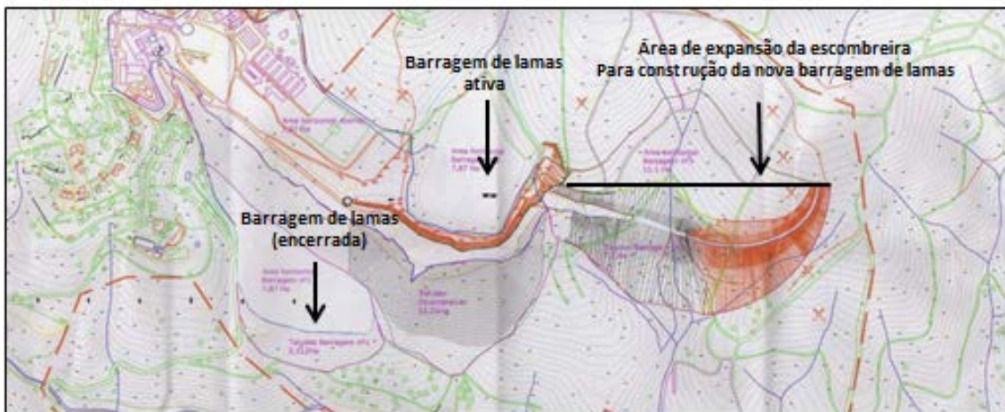
Figura 4.1 e 4.1 A – Escombreyra ativa da Barroca Grande. Em cima fotografia aérea (junho 2012) http://portugalfotografiaaerea.blogspot.pt/2012/06/minas-da-panasqueira.html onde se pode ver a área expandida para a construção da nova barragem de lamas. Carta topográfica do plano de expansão da escombreyra, elaborado já em 02.2010, com o plano de avanço. Gentilmente cedida pela S.B.T.W.P.
