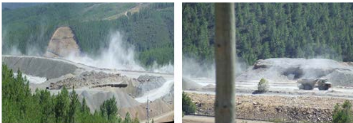
Figura 3.10 - A passagem de camiões ao longo da escombreira, sem que o caminho seja alvo de rega, provoca o levantamento de grande quantidade de poeira (fotos do autor Agosto de 2011).
