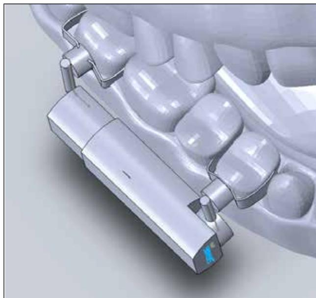
Figura I.7 - Desenho em SolidWorks® do PATD.
