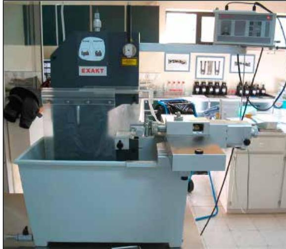
Figura 2.36 - Sistema Exakt® para processamento histológico de material não descalcificado instalado no Laboratório de Tecidos Duros da FMUC.
