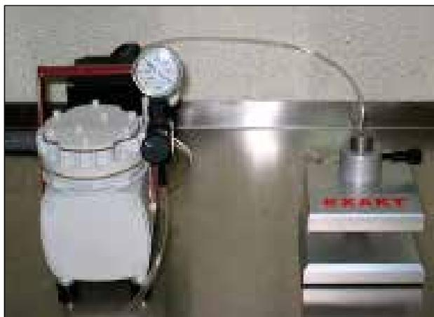
Figura 2.46 - Montagem da primeira lâmina em prensa com vácuo.
