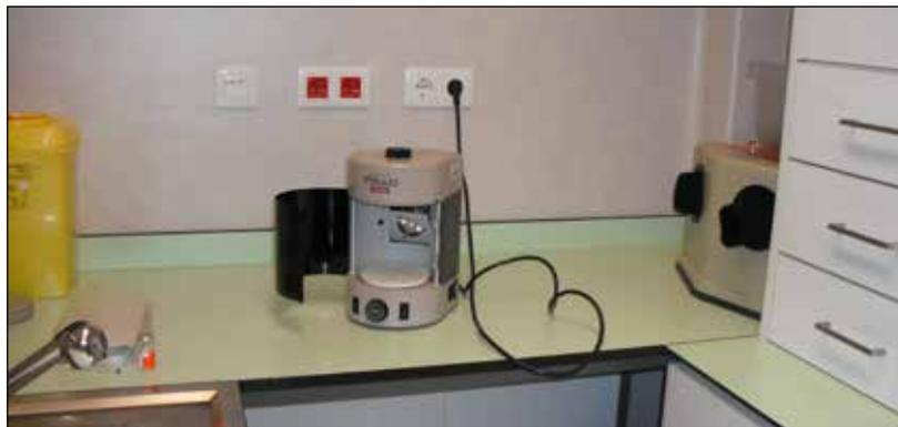
Figura 2.6 - Fotopolimerizador utilizado na construção das moldeiras individuais.
