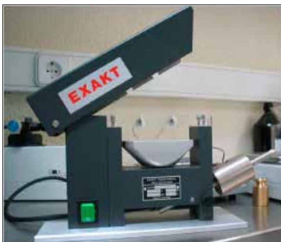
Figura 2.48 - Prensa fotopolimerizadora para montagem da segunda lâmina pela técnica da *sandwich*.
