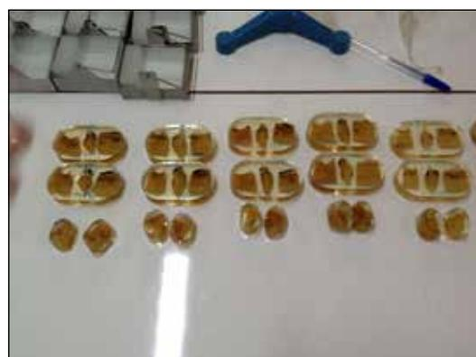
Figura 2.43 - Amostras incluídas em blocos de acrílico.
