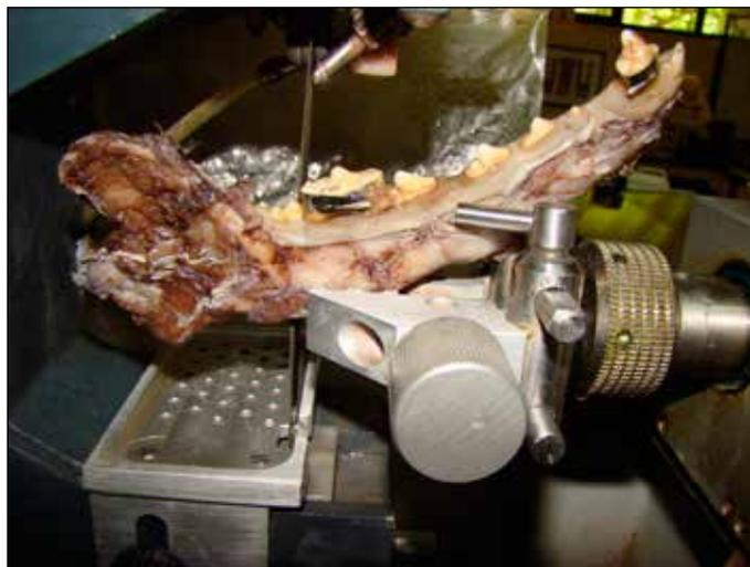
Figura 2.38 - Hemimandíbula sujeita a corte no Sistema Exakt®.
