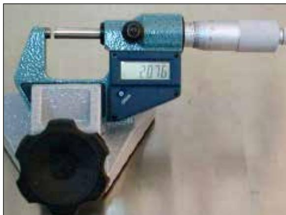
Figura 2.51 - Micrómetro digital para controlo da espessura final da lâmina.
