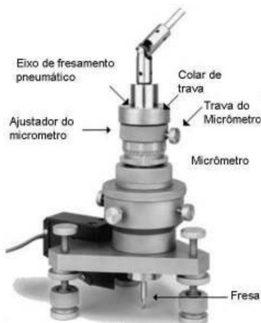
Figura 8 - Detalhes do equipamento de furação ( Vishay-Measurements Group, 2007 ).
