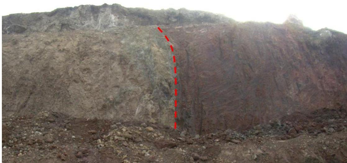
Fig. 9-3 – Falha a interceptar a Formação de Dagorda. Talude W do parque de estacionamento do edifício A da ESTG. Falha - - - -
