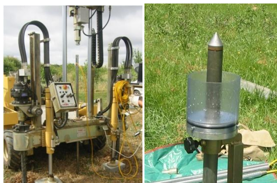
Fig. 5-2– Equipamento para a realização do CPTU e Ponteira cónica do CPTU.
