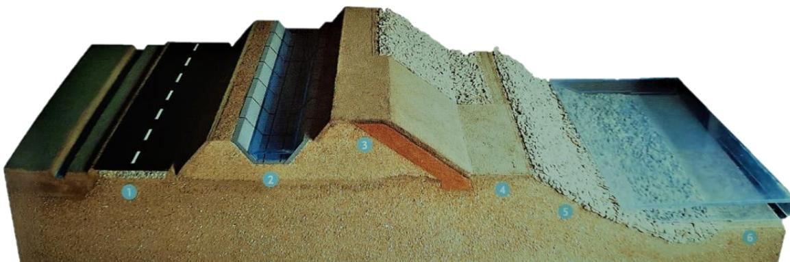
*Figura 70.* Maqueta com as obras de regularização do Baixo Mondego. Legenda: (1) Estrada adjacente; (2) Canal de rega; (3) Dique; (4) Leito maior; (5) Enrocamento; (6) Leito menor. Fonte: Adaptado de C. O. Santos (2013).
