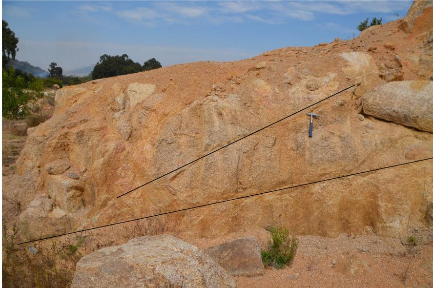
Figura 4.20. Diaclases em granite preenchidas (Estação 2).
