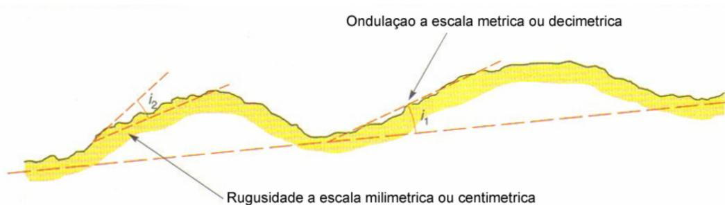
Figura 4.17. Esquema representativo da rugosidade de uma diaclase.
