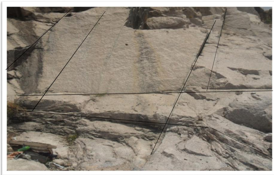
Figura 4.7. Granito de grão fino da estação 1 do sector SE/SW com diferentes diáclases
