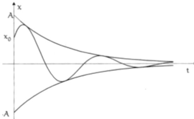
Figura 4 – Um exemplo da representação gráfica do movimento sub-amortecido para o caso de  $x(0) > 0$  e  $x'(0) > 0$
