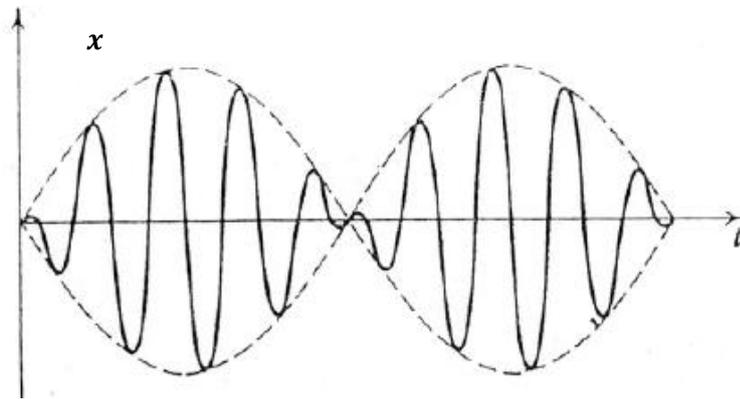
Figura 8 – Um exemplo da representação gráfica do movimento forçado não amortecido quando a diferença entre a frequência natural e a frequência externa é pequena
