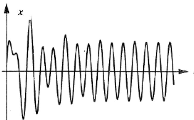
Figura 5 – Um exemplo da representação gráfica do movimento forçado com amortecimento
