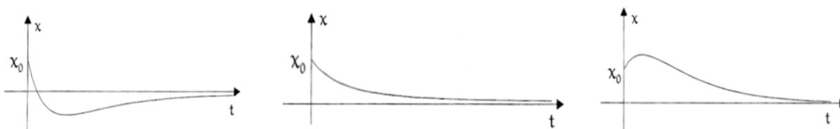
Figura 3 – Três exemplo do movimento harmónico super-amortecido para o caso de  $x(0) > 0$
