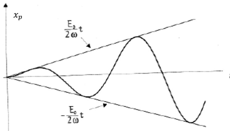
Figura 6 – Um exemplo da representação gráfica do movimento apresentado por uma solução particular, para o caso da ressonância
