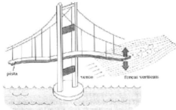
Figura 10 – Deslocamentos verticais na ponte de Tacoma Narrows
