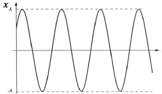
Figura 2 – Um exemplo da representação gráfica do movimento harmônico simples para uma situação em que  $0 < x(0) < A$  e  $x'(0) > 0$
