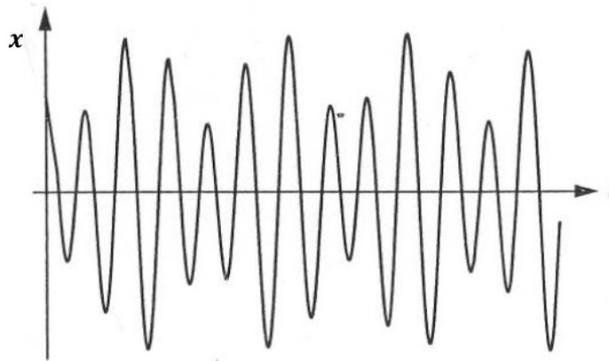
Figura 7 – Um exemplo da representação gráfica do movimento forçado não amortecido não periódico, para o caso de  $x(0) > 0$  e  $x'(0) < 0$
