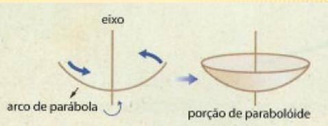
Há diversas aplicações práticas do parabolóide, nomeadamente na óptica, na acústica e na tecnologia, devido a uma propriedade reflectora da parábola.
